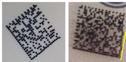
Нарушение геометрии кода маркировки (модуляция)
