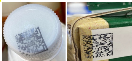
Смещение кода маркировки при печати
