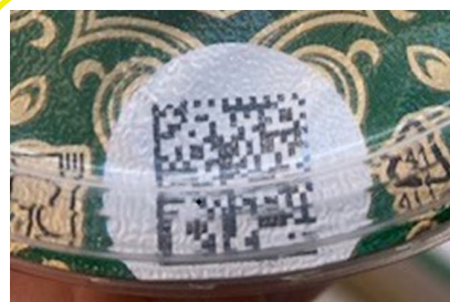
Отсутствие ровного рельефа
