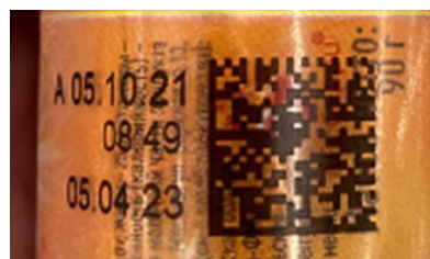
Печать кода маркировки на бликующей/светлоотражающей поверхности
