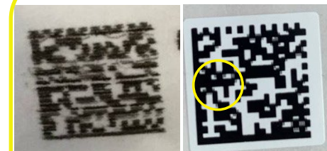
Смазывание кода маркировки или его отдельных элементов
